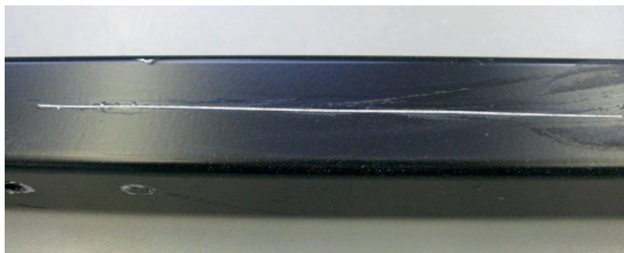
Neutrale Reinigung, zirkoniumbasierende Konversionsschicht und leistungsfähiger Lack gewährleisten mehr als 240 h Beständigkeit im Cass-Test
